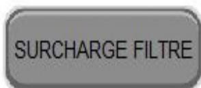
Lorsque l'encrassement maximal des filtres est atteint, le ventilateur du système s'arrête. Pour permettre le fonctionnement de l'épurateur ou de la hotte Stadium tout en sachant que les filtres sont encrassés, il faut appuyer sur le bouton « SURCHARGE FILTRE ». Ce bouton est situé sur la page principale de l'épurateur.
