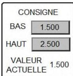
Si un système à vitesse variable ou 2 vitesses est utilisé, 2 consignes de pression doivent être entrées.
