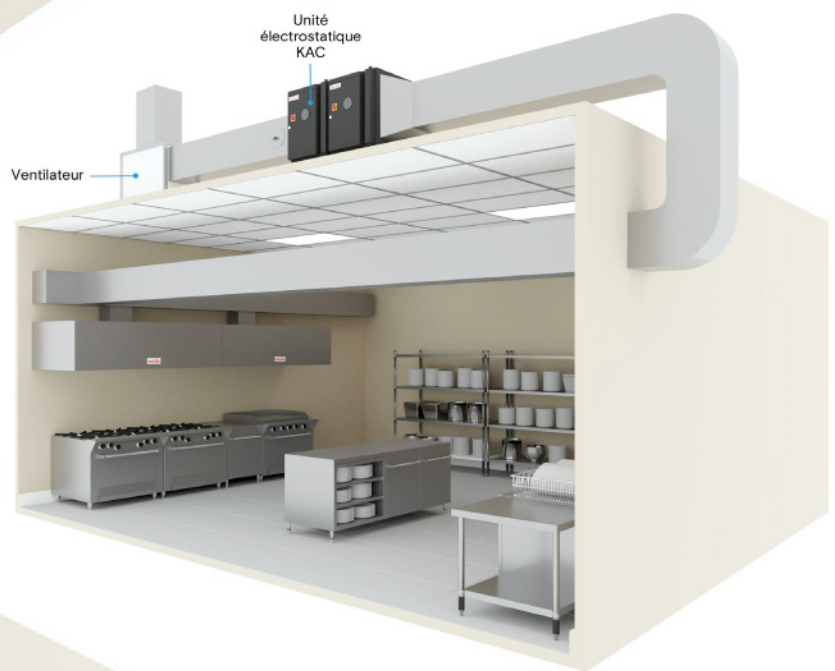
Installation extérieur avec sortie au toit
