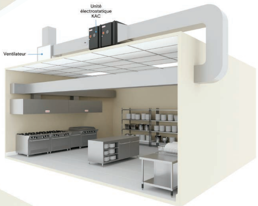
Installation extérieure avec sortie au toit
